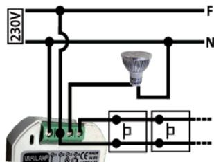
Control mediante pulsadores. Admite hasta 5 pulsadores en paralelo con indicador luminoso (neón o LED) e ilimitado sin indicador luminoso.
