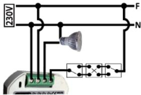
230V (AC) - 250W Máx. LED REGULABLES, HALÓGENOS E INCANDESCENCIA
