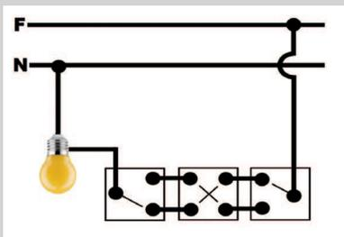
Instalación típica de conmutadas y cruzamiento.
