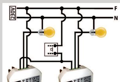
Se conecta cada regulador a fase y a su carga sin superar su potencia máxima. El/los pulsador/es se conecta/n a las entradas de pulsador de cada regulador en paralelo. Esquema válido para los demás reguladores de pulsación a 230V.
